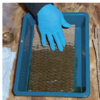
デクルムで裁断後のデクルムシート 柔らかく、表面積も増え吸着せがよい
